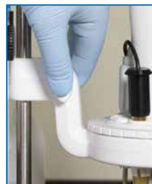
Support d'électrodes coulissant avec agitateur à hélices intégré
