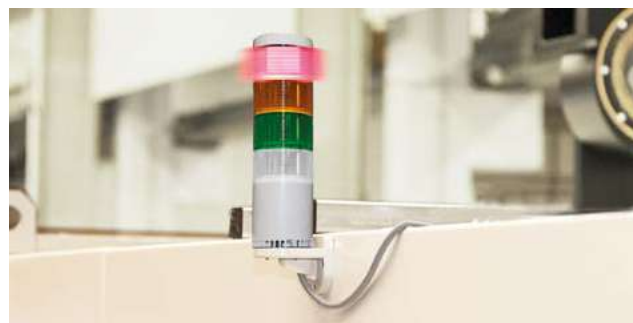
Lampe de signalisation pour l'indication visuelle d'une alarme
