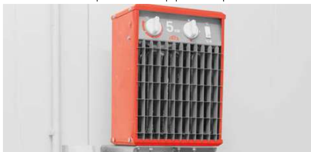
Le système de chauffage de 5 kW de conception non ATEX, combiné à l'isolation thermique, assure une température intérieure de + 5 °C par -15 °C de température extérieure
