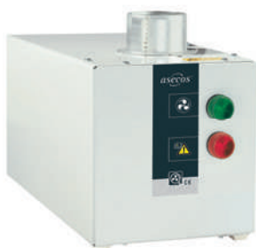
Unité d'extraction pour le montage sur l'armoire, pour toutes les armoires, avec contrôle du débit d'air, Conforme CE : CE II 3/-G Ex ic nA IIB T4 Gc, anti-déflagrant, Extraction de : Zone EX 2 / Montage : en dehors de la zone EX Code article 14220
