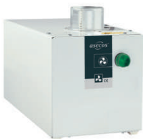
Unité d'extraction pour le montage sur l'armoire, pour toutes les armoires, Conforme CE : CE II 3/-G Ex ic nA IIB T4 Gc, anti-déflagrant, Extraction de : Zone EX 2 / Montage : en dehors de la zone EX Code article 14218
