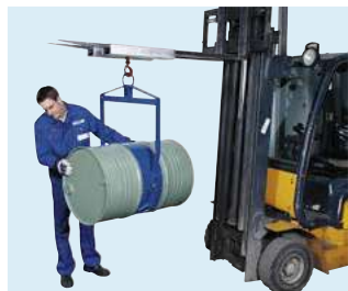
Version avec collier de serrage • Fût en acier verrouillable en position verticale et horizontale Code article 19257
