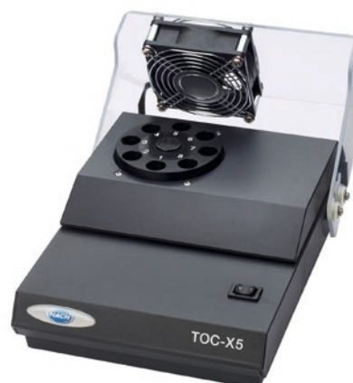
Agitateur TOC-X5 pour purger le carbone inorganique (TIC) afin de déterminer le COT avec LCK385, LCK386 et LCK387.
